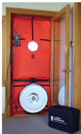
Uitvoeren van een blowerdoortest
