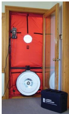
Uitvoeren van een blowerdoortest
