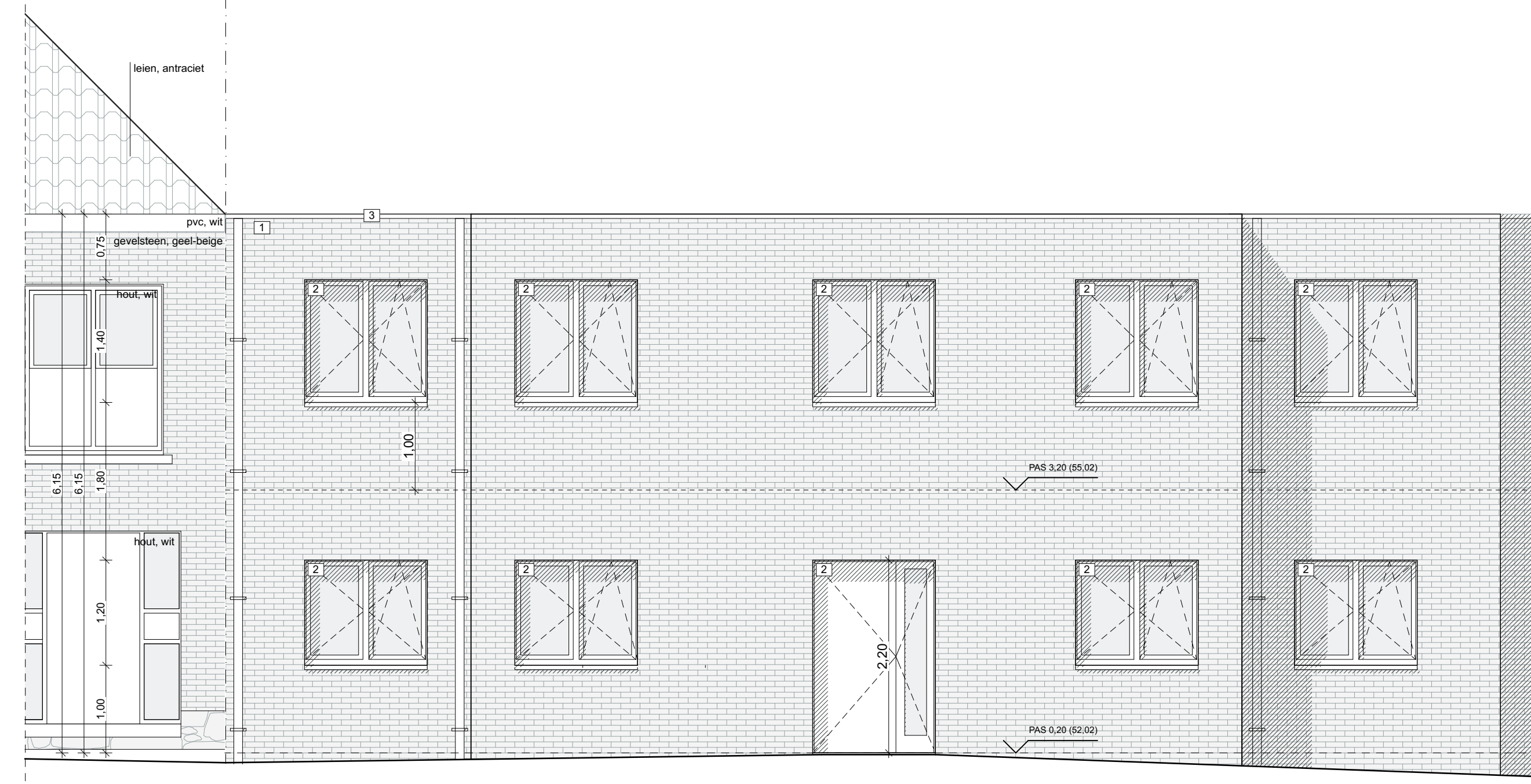
STRAATGEVEL LINKER BLOK schaal 1/50, maataanduiding in meter.
