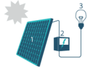
1. Zonnepaneel | 2. Omvormer | 3. Elektrische toestellen
