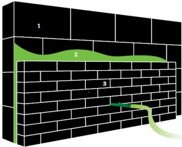
1. Dragende muur | 2. Ingeblazen isolatie | 3. Gevelsteen / gevelbekleding
