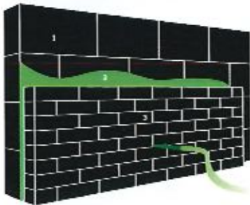
1. Dragende muur | 2. Ingeblazen isolatie | 3. Gevelsteen / gevelbekleding
