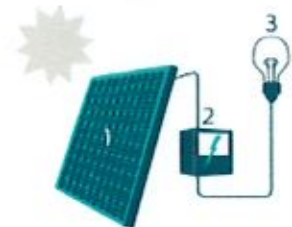
1. Zonnepaneel | 2. Omvormer | 3. Elektrische toestellen
