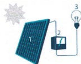
1. Zonnepaneel | 2. Omvormer | 3. Elektrisch toestel
