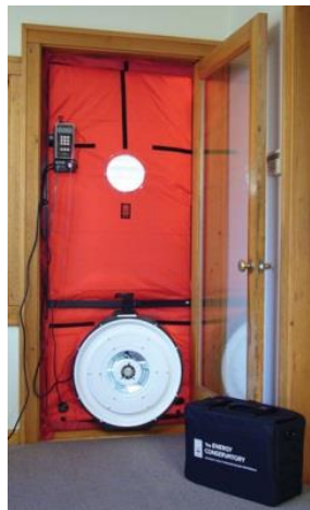
Uitvoeren van een blowerdoortest
