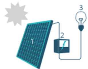
1. Zonnepaneel | 2. Omvormer | 3. Elektrische toestellen
