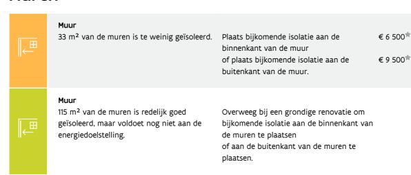
Bij de isolatie van de muren kunt u het best streven naar een U-waarde van maximaal 0,24 W/(m²K). Dat komt overeen met een isolatielaag van ongeveer 14 cm minerale wol, EPS of XPS ( $\lambda_d = 0.035 \text{ W/(mK)}$ ) of 10 cm PUR of PIR ( $\lambda_d = 0.023 \text{ W/(mK)}$ ). Als u de isolatie tussen regelwerk plaatst, breng dan minstens 6 cm extra isolatie aan.
