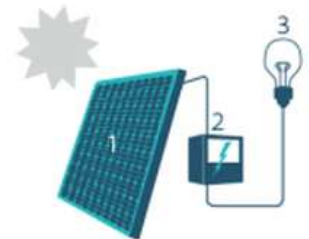
1. Zonnepaneel | 2. Omvormer | 3. Elektrische toestellen
