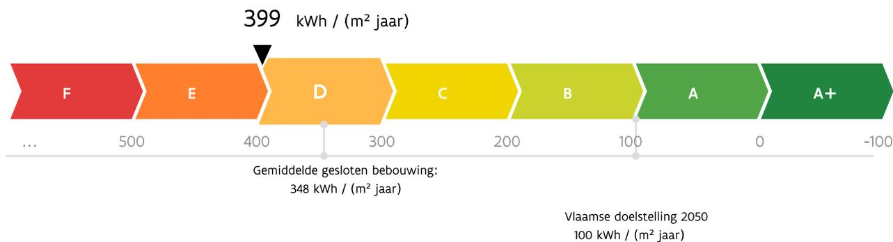
De energiescore en het energielabel van deze woning zijn bepaald via een theoretische berekening op basis van de bestaande toestand van het gebouw. Er wordt geen rekening gehouden met het gedrag en het werkelijke energieverbruik van de (vorige) bewoners. Hoe lager de energiescore, hoe beter.
