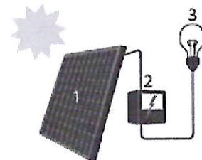
1. Zonnepaneel | 2. Omvormer | 3. Elektrische toestellen
