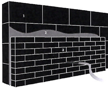
1. Dragende muur | 2. Ingeblazen isolatie | 3. Gevelsteen / gevelbekleding
