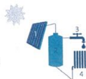
1. Zonnecollector | 2. Opslagvat voor warm water | 3. Warm water uit de boiler | 4. Afgelevert naar ruimteverwarming (b.v. radiatoren)
