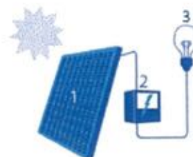
1. Zonnepaneel | 2. Omvormer | 3. Elektrische toestel(len)
