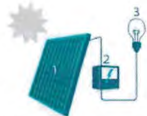
1. Zonnepaneel | 2. Omvormer | 3. Elektrische toestellen
