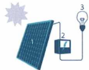
1. Zonnepaneel | 2. Omvormer | 3. Elektrische toestellen
