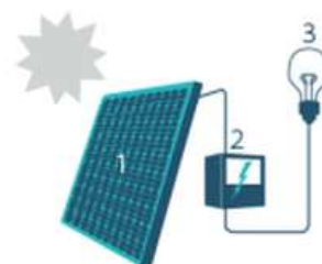
1. Zonnepaneel | 2. Omvormer | 3. Elektrische toestellen
