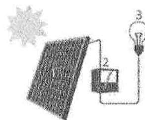
1. Zonnepaneel | 2. Omvormer 3. Elektrische toestellen
