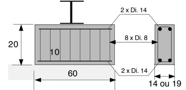
Les cloisons d'épaisseur de 10 cm seront de préférence en métal stud ou en blocs treillis super-légers, il est proscrit les blocs béton à moins de réaliser une poutre inversée en béton de 20 cm de haut.
