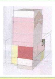
Le volume protégé d'un logement reprend tous les espaces du logement que l'on souhaite protéger des déperditions thermiques que ce soit vers l'extérieur, vers le sol ou encore des espaces non chauffés (cave, annexe, bătiment mitoyen...). Il comprend au moins tous les locaux chauffés. Lorsqu'une paroi dispose d'un isolant thermique, elle délimite souvent le volume protégé.
