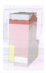
Le volume protégé d'un logement reprend tous les espaces du logement que l'on souhaite protéger des déperditions thermiques que ce soit vers l'extérieur, vers le sol ou encore des espaces non chauffés (cave, annexe, bâtiment mitoyen...). Il comprend au moins tous les locaux chauffés. Lorsqu'une paroi dispose d'un isolant thermique, elle délimite souvent le volume protégé.
