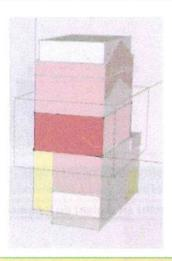
Le volume protégé d'un logement reprend tous les espaces du logement que l'on souhaite protéger des déperditions thermiques que ce soit vers l'extérieur, vers le sol ou encore des espaces non chauffés (cave, annexe, bătiment mitoyen...). Il comprend au moins tous les locaux chauffés. Lorsqu'une paroi dispose d'un isolant thermique, elle délimite souvent le volume protégé.
