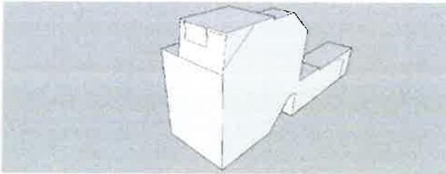
Le volume protégé d'un logement reprend tous les espaces du logement que l'on souhaite protéger des déperditions thermiques que ce soit vers l'extérieur, vers le sol ou encore des espaces non chauffés (cave, annexe, bâtiment mitoyen...). Il comprend au moins tous les locaux chauffés. Lorsqu'une paroi dispose d'un isolant thermique, elle délimite souvent le volume protégé.
