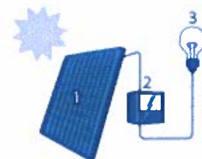
1. Zonnepaneel | 2. Omvormer 3. Elektrische toestellen
