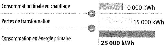
À l'inverse, en cas d'auto-production d'électricité (via panneaux photovoltaïques ou cogénération), la quantité d'énergie gagnée est aussi multipliée par 2,5 ; il s'agit alors de pertes évitées au niveau des centrales électriques.
